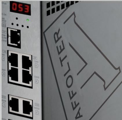
Toutes nos machines sont équipées de commandes **CNC Affolter Leste**, allant jusqu'à **12 axes**. La vitesse d'interpolation est extrêmement rapide avec des cycles de **90 ns** ! Ceci se traduit par une vitesse et une dynamique incomparable.
