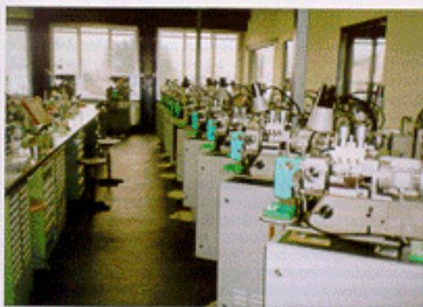
Fig. 4: Fabrication des pignons / atelier de taillage (travail des dentures). Ritzensteilung / Wälzfräsen (Ausfräsen der Zähne). Manufacturing pinions / cutting workshop (tooth cutting).
