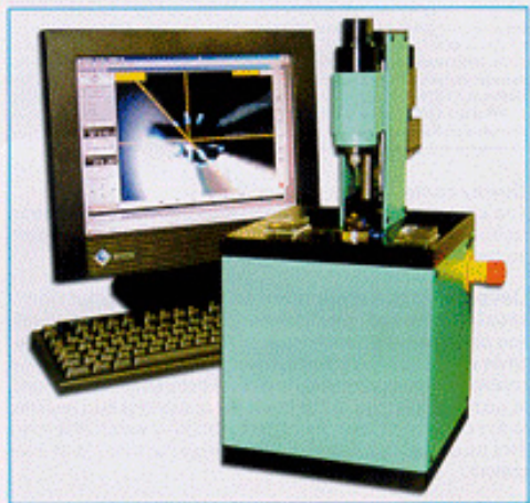
Fig. 8: Appareil CNC à assemblage de rouages avec indexage par caméra CCD. L'image de la caméra CCD est intégrée dans le logiciel PC qui commande la CNC. CNC-gesteuertes Montageapparat für Triebe mit Indexierung über CCD-Kamera. Das Bild der CCD-Kamera ist in die Software des PC integriert, der die CNC-Steuerung absichert. CNC equipment for assembling gear trains, with indexing by CCD camera. The camera's image is integrated into the PC software which controls the CNC.
