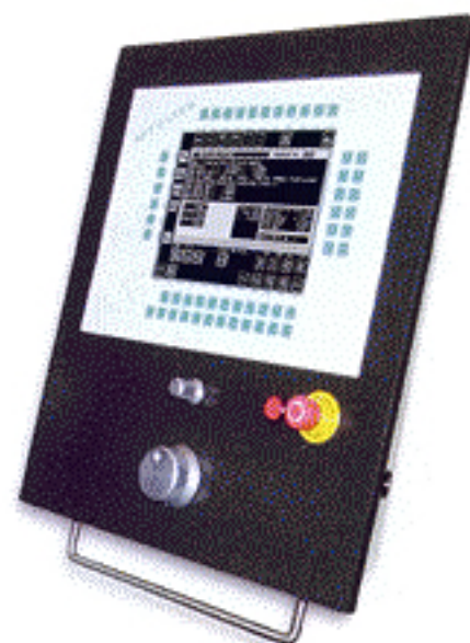
Панель управления HMI 52-VGA дает возможность выполнить подключение системы управления к любому станку путем простейшей настройки параметров.
