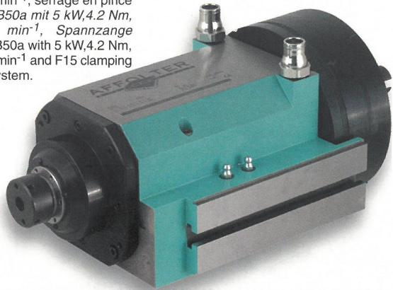
von 0 auf 20'000 min-1 in weniger als 500 ms beschleunigt. Die Präzision muss sehr hohen Anforderungen genügen. Der Hersteller konstruiert Motorspindeln nach Mass. Bezuglich Spannsystem, Leistung, Drehzahl und Masse, kann Affolter massgeschneiderte Lösungen anbieten.
