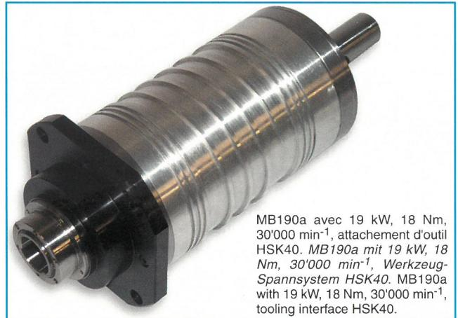
MB190a avec 19 kW, 18 Nm, 30'000 min<sup>-1</sup>, attache-outil HSK40. MB190a mit 19 kW, 18 Nm, 30'000 min<sup>-1</sup>, Werkzeug-Spannsystem HSK40. MB190a with 19 kW, 18 Nm, 30'000 min<sup>-1</sup>, tooling interface HSK40.
