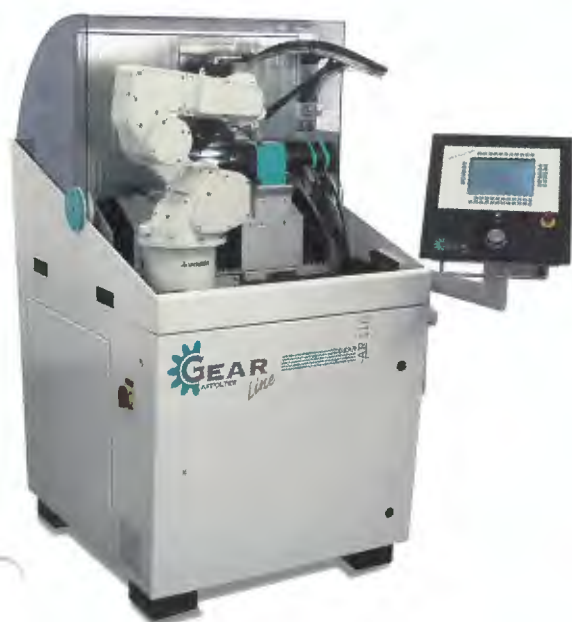
La machine à tailler AF 110 équipée d'un robot de manipulation.
