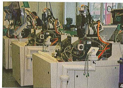
Die Technologieentwicklung ist bei Affolter Pignons exzellent zu erkennen. Von links nach rechts: Kurvenautomaten, CNC-modernisierte Kurvenautomaten und Montage der modernsten CNC-Maschinen bei Affolter Technologies SA.
