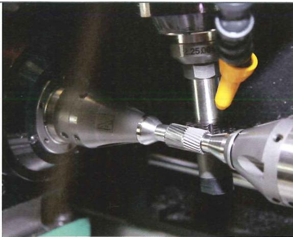
**2** Mit der Technologie  $\mu$ -Skiving lassen sich Zahnräder im Modulbereich von 0,1 bis 1,0 im Schälfräsverfahren hochgenau fertigen
