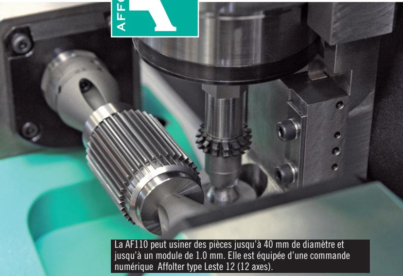
La AF110 peut usiner des pièces jusqu'à 40 mm de diamètre et jusqu'à un module de 1.0 mm. Elle est équipée d'une commande numérique Affolter type Leste 12 (12 axes).
