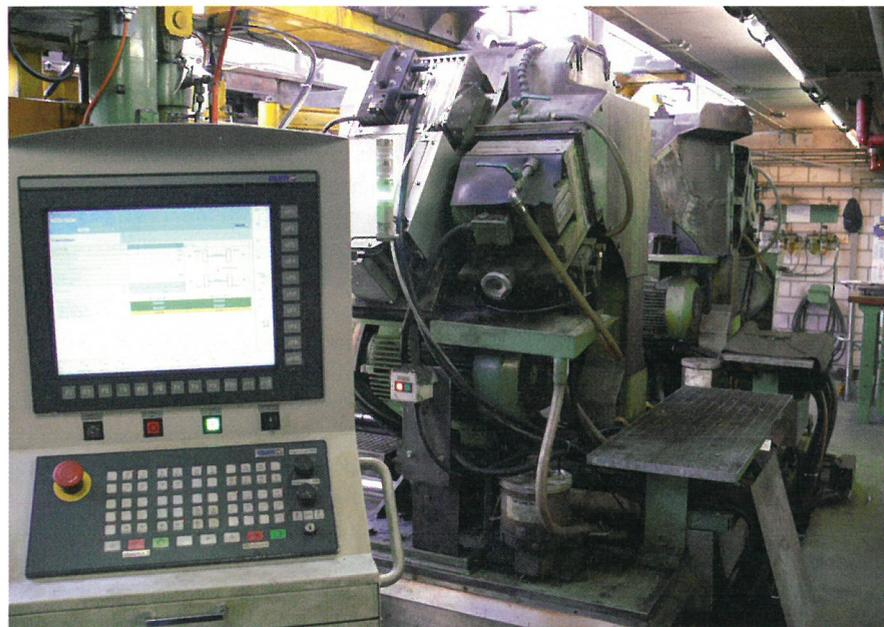
Commande CNC NUM pour machine de tournage.
