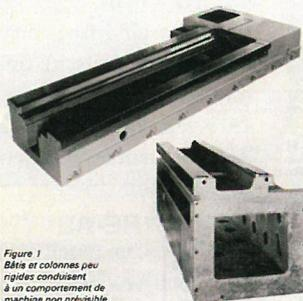
Figure 1 Bâti et colonnes peu rigides conduisant à un comportement de machine non prévisible.
