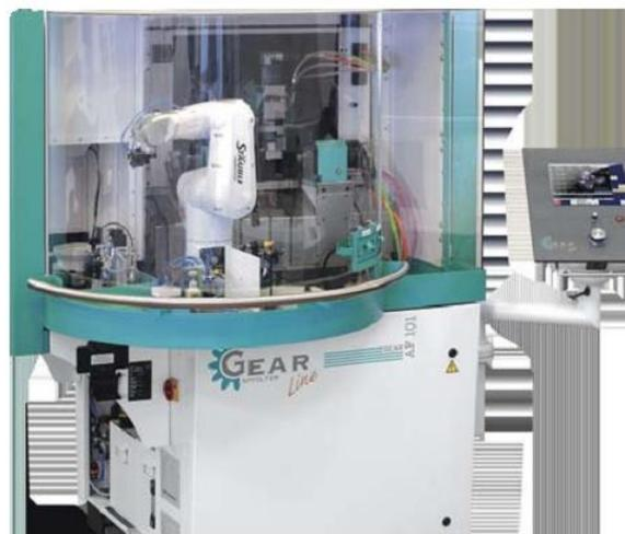
Centre de taillage Gear AF101 avec robot de chargement/déchargement incorporé.
