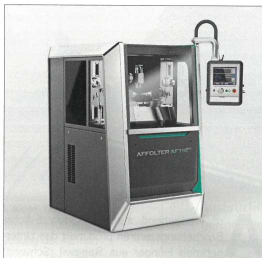
Bilder 1 und 2. Produktivitätsschub: Das neue Verfahren Worm Screw Power Skiving (WSPS) ist laut Hersteller viermal schneller als das Wälzfräsen
