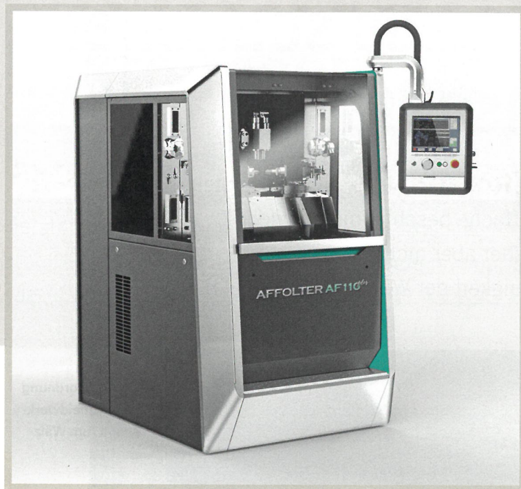
Bild 2. Verzahnungsbearbeitungszentrum 'AF110 plus', das speziell für den WSPS-Prozess optimiert ist
