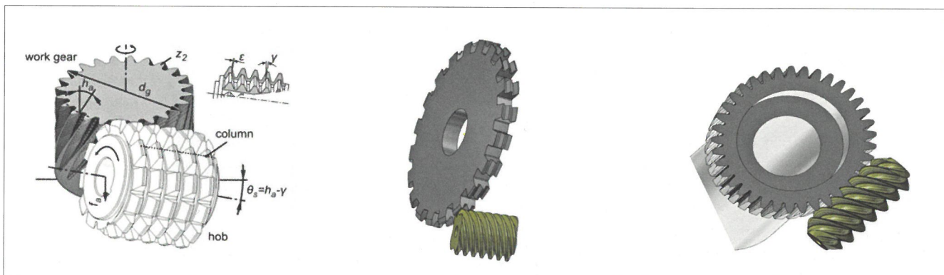
Bild 3. Unterschiedliche Verfahren zur Herstellung von Schneckenschrauben: Wälzfräsen (links), Schneckenfräsen (Mitte) und das Worm Screw Power Skiving (rechts)
