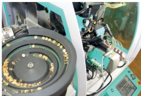
**Fig. 4** - Caricatore a tamburo per pezzi di piccole dimensioni.
