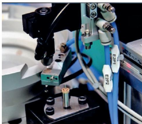
**Fig. 5** - Piccolo ingranaggio caricato automaticamente su mandrino ad asse verticale.
