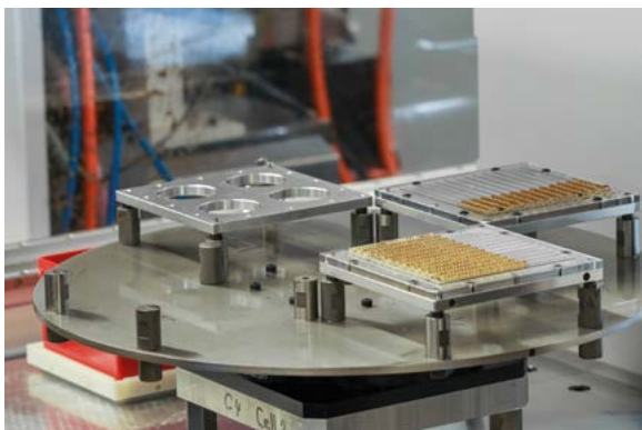
Le transfert des pièces d'une cellule à la suivante est géré à travers un plateau rotatif.
