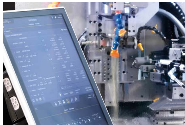
L'interface utilisateur de la commande numérique Pegasus impressionne par son grand écran tactile et sa facilité d'utilisation.
