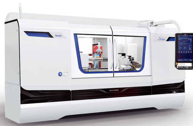
4 Die 'Favorit' ist eine CNC-Universal-Rundschleifmaschine für kurze bis lange Einzel- oder Serienteile. Es gibt sie mit Spitzenweiten von 400, 650, 1000 und 1600 mm und mit 175 mm Spitzenhöhe. Bis 150 kg schwere Teile sind bearbeitbar, außen und innen in einer Aufspannung © Studer
