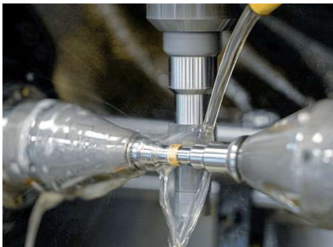
Une vitesse inégalée : la broche de fraisage de la nouvelle AF140 atteint 16 000 tr/min et des vitesses de pièce allant jusqu'à 5000 tr/min, offrant une précision et une efficacité exceptionnelles.
